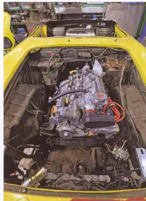
(左) FRPボディのこのSはお客さんのクルマ。リジッドのリア・サスペンションがわかる。ただいまエンジンをおろして修繕中。ちょっと剛性感がないけれど、100kg軽いから軽快。「私みたいに軽いのが乗ったら150kgは軽い」と岩佐さん。運転すると別物感があるという。(右)レモン・イエローのこの個体は1968年のS800Mの左ハンドル。ちゃんと走っていたクルマだから大丈夫だと思って、フロントの一部だけボディを直そうと剥いてみたら、ひどい状態だった。結局ボディは全部やり直し。最近黄色ばかりになっているから赤にする予定。趣味で塗り替え。
