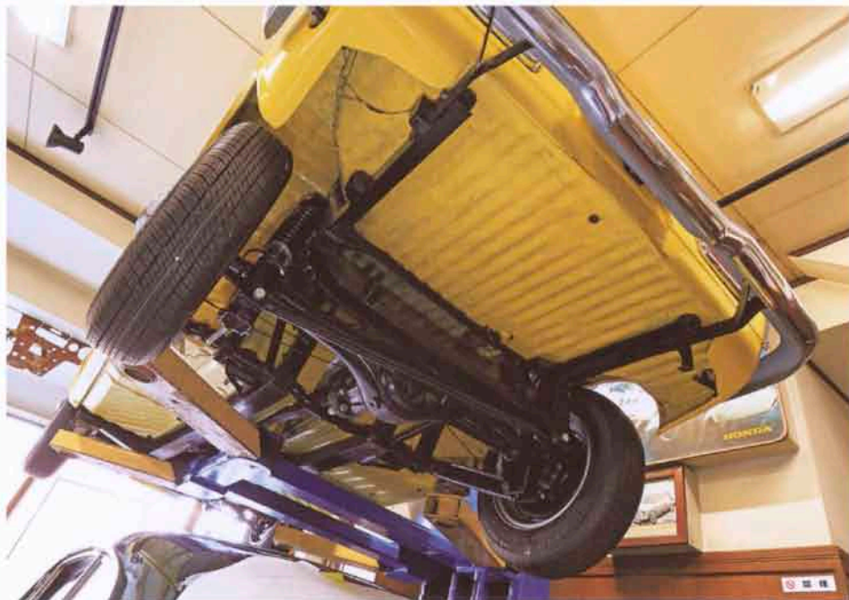
(左) FRPボディのこのSはお客さんのクルマ。リジッドのリア・サスペンションがわかる。ただいまエンジンをおろして修繕中。ちょっと剛性感がないけれど、100kg軽いから軽快。「私みたいに軽いのが乗ったら150kgは軽い」と岩佐さん。運転すると別物感があるという。(右)レモン・イエローのこの個体は1968年のS800Mの左ハンドル。ちゃんと走っていたクルマだから大丈夫だと思って、フロントの一部だけボディを直そうと剥いてみたら、ひどい状態だった。結局ボディは全部やり直し。最近黄色ばかりになっているから赤にする予定。趣味で塗り替え。
